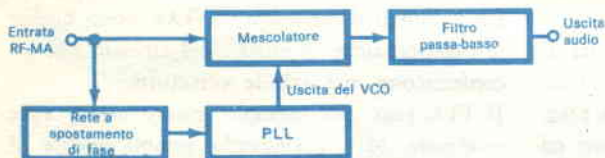
Fig. 2 - Schema a blocchi semplificato del circuito a blocco di fase, che illustra come l'oscillatore a tensione controllata viene tenuto al passo con il segnale d'entrata a frequenza variabile.
