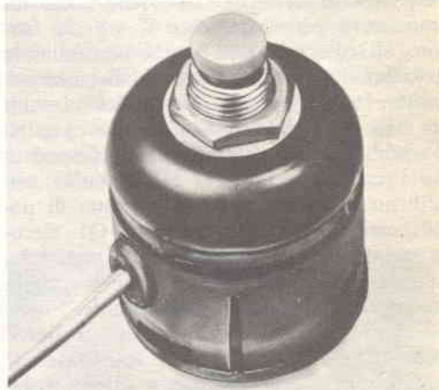
Fig. 6 - Ecco l'interruttore a pulsante montato in una scatoletta. Il cavo elettrico di comando a distanza passa attraverso un foro ben guarnito con un gommino.
