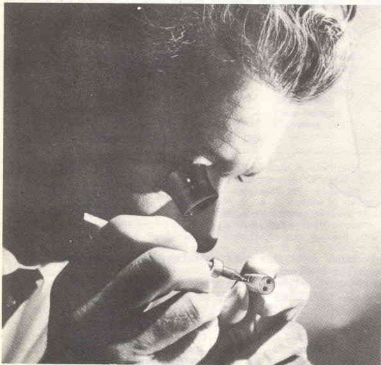
Il dott. James Zimmerman regola il suo dispositivo superconduttore di "quanti di interferenza", detto SQUID, un trasduttore da lui inventato, che ha il compito di controllare l'attività elettrica che è presente nel corpo umano. Tale dispositivo permette il controllo esterno per mezzo di campi misurabili.
